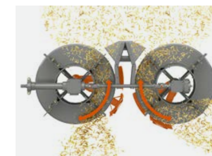
Distribuidor radial para distribuição eficiente da palha com o mínimo de esforço.
